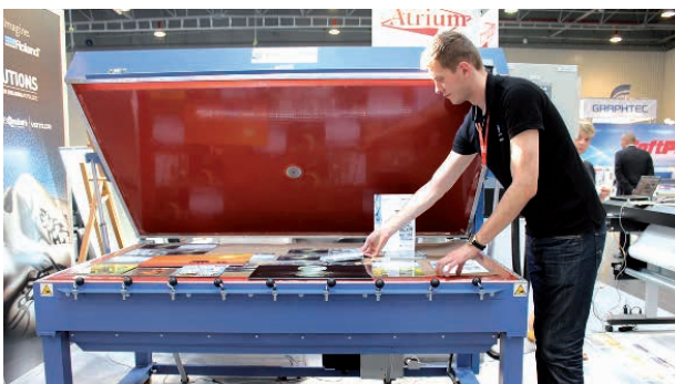
Firma KML Solutions promowała piec do laminowania szkła UL-1500, który razem z ploterem Roland stanowi kompletny zestaw do produkcji laminowanych tafli szkła typu sologlass
