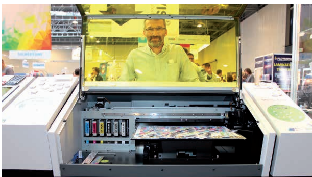
Michał Wiesner (PolKos) i „magiczne pudełko”: maszyna „Magic Box” Roland VersaUV Lef-300 do zadruku gadżetów. To nowa wersja poprzedniego modelu, o m.in. większym polu zadruku i dodatkowej głowicy
